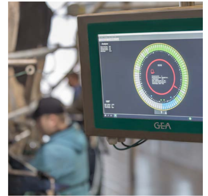
Выполняемые в настоящее время работы на доильном месте отображаются на мониторе.
